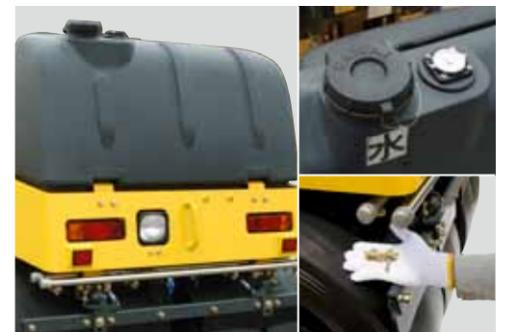
液剤噴霧システムには、樹脂製液剤タンク、ステンレス製パイプ、金属製ワンタッチノズルを標準装備することで、タイヤへのアスファルト合材の付着を抑制します。
